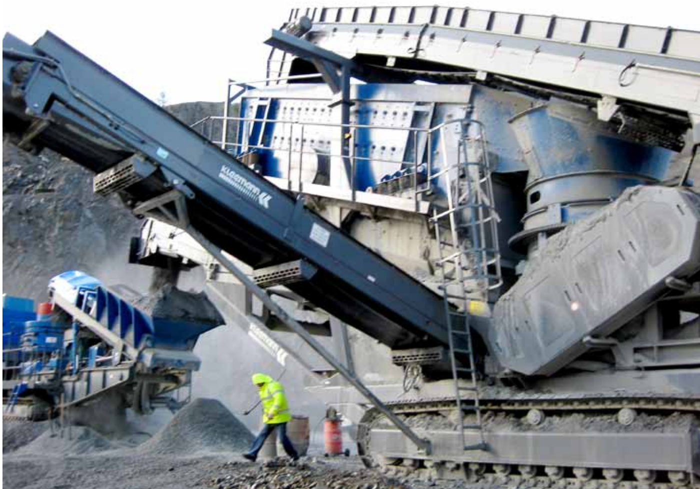
Valget falt på en Kleemann konknuser MCO 13 S – et beltegående finknuseverk på 110 tonn, og er dermed et av Norges største mobile finknuseverk.
